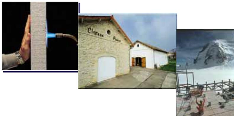
D'autre part, dans les conditions extrêmes d'un incendie, le mur en Thermopierre présente une résistance au feu exceptionnelle supérieure à 6h00, durée maximale de l'essai, dès 15cm d'épaisseur.
