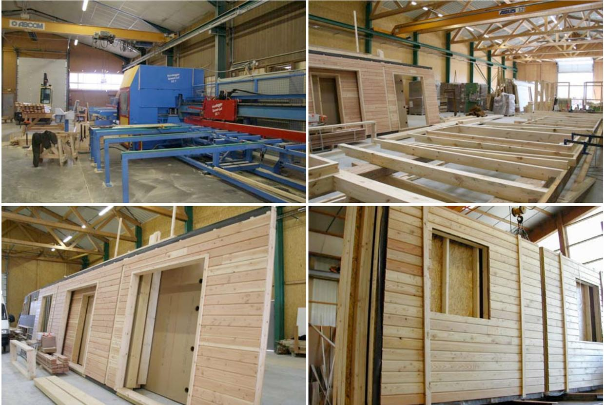
Principales étapes de la fabrication : Découpe des bois, assemblages des composants, mise en place des différentes solutions de finitions (Bardage, panneau plan, enduit minéraux, ...), insertion des isolants et mise en place du pare-vapeur.
