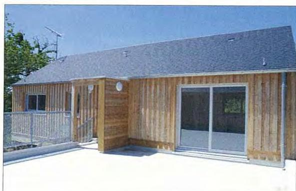
Vue du bardage vertical à couvre joint
