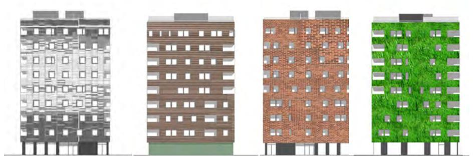
Grande variété de matériau de façade applicable : panneaux fibre de ciment, bardage bois, briques, mur végétal etc.
