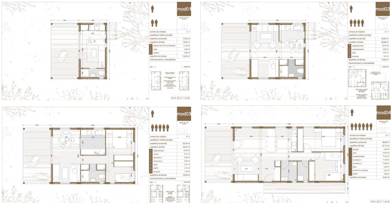
exemples de distribution et ampliation du système: de 1 à 4 modules (18 à 72 m 2 )
