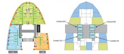
Principes de ventilation et encombrement des conduits
