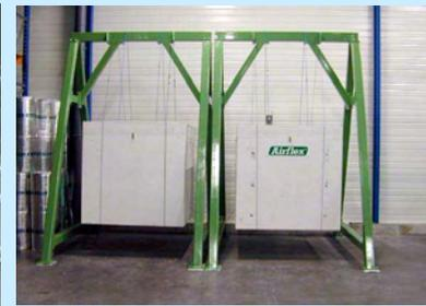
Expérimentation industrielle en différentiel entre 2 enceintes contenant des isolants différents
