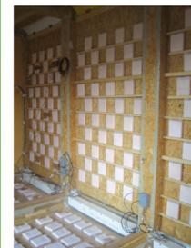
Briques (en polyoléfine) de matériaux à changement de phase (MCP) disposées en surface intérieure au volume
