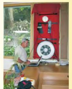
Mesure de la perméabilité (Essai Blower Door)
