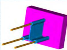
Le marché visé est le marché résidentiel collectif (le tertiaire n'est pas exclu dans un deuxième temps) dans le cas de planchers coulés en place. Les applications types du rupteur sont les traitements des liaisons façade-plancher dans les cas des planchers bas, intermédiaire et haut.
