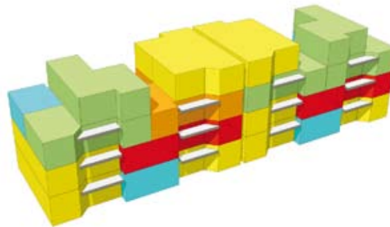
COMBINAISON DE MODULES POUR DU COLLECTIF R+3
